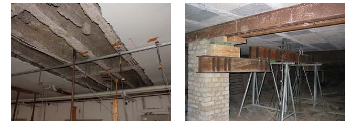
Bild 6: Messpunkte (links) und Lastverankerung (rechts)
